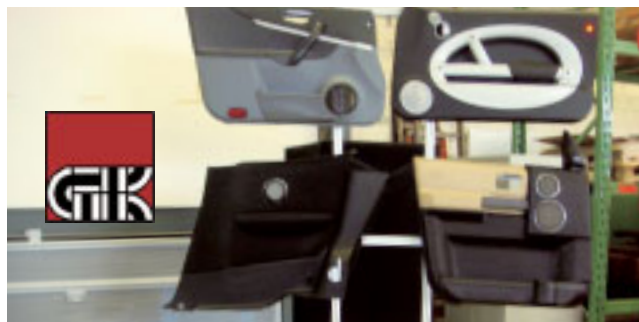
Hier wird Präzisionswerkzeug für die Verfahrenstechniken des Hinterspritzens und Hinterpressens sowie für GMT-Formteile entwickelt und produziert. Das sieht dann so aus: Musser-Türverkleidungen von Autos bekannter Marken.
