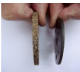
Links: die „richtige“ Dichtung vom Spezialisten aus UK. Rechts die Gummidichtung. Erste war aber auch nicht OK, sondern ein Gummi-Kork Gemisch, das quoll.
